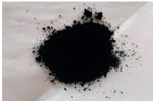
Многостенные углеродные нанотрубки (МУНТ), полученные методом химического осаждения
