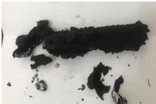
Многостенные углеродные нанотрубки (МУНТ), полученные методом дугового разряда
