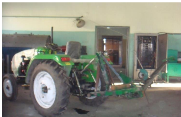
Рисунок 6. Тракторная косилка КС-2.1М производства МонНИИТТСХ.
