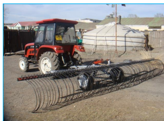
Рисунок 7. Тракторные грабли ГПГ-6М производства МонНИИТТСХ.
